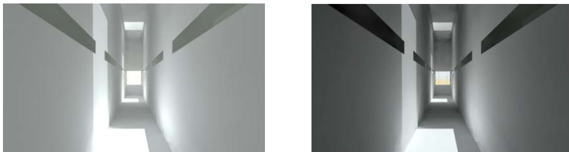
FIGURA 15 – À ESQUERDA, SIMULAÇÃO DAS LUMINÂNCIAS ENCONTRADAS NO CORREDOR E À DIREITA UMA REPRODUÇÃO DA VISÃO HUMANA DO MESMO ESPAÇO
